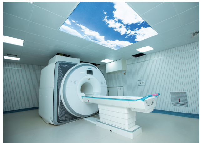
西门子“准7T”MAGNETOM Prisma 3.0T磁共振成像设备（MRI）
