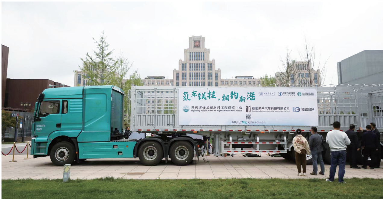
西安交通大学联合陕西汽车控股集团有限公司等多家单位研发的我国首辆镁合金轻量化挂车在创新港交付
