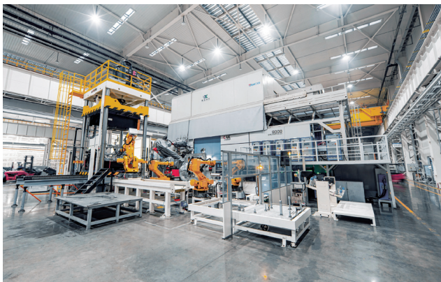
万吨级超级智能压铸单元，可以将车架一次性压铸成型。
