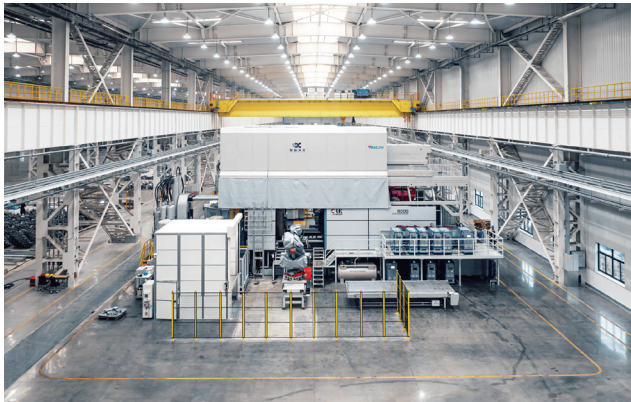
赛力斯超级工厂当中，与文灿集团合作运行的超级一体化压铸机。
