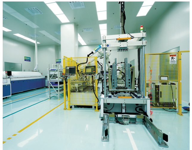
旭氢时代全自动化氢燃料电池堆生产线
